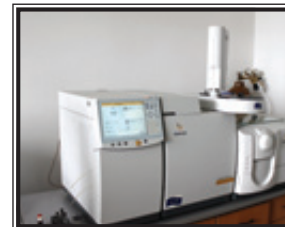
GC/MS-гасен хроматограф за анализа на масти и масла од растително и животинско потекло
