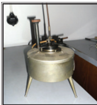
Апарат за утврдување на точка на палење во 1993 година
