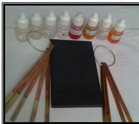
Одредување на проценти на злато (накит) со метод на абразивна плоча со каратни игла
