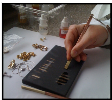
Одредување на проценти на злато (накит) со метод на абразивна плоча со каратни игла
